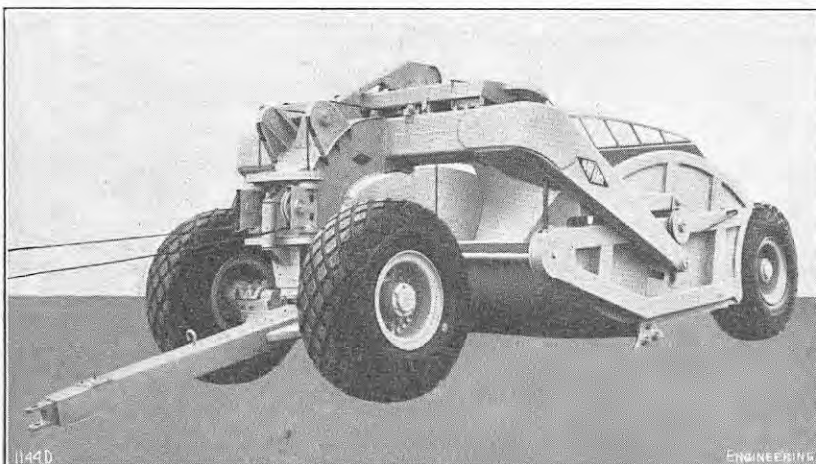
FIG. 15. 7 1/2 CUB. YD. SCRAPER ; BLAW-KNOX, LTD.
